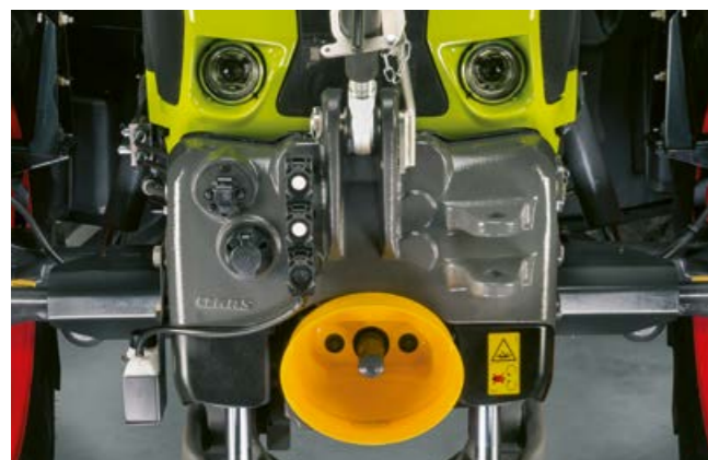
Esirippüsteemil on liitmikud ühele hüdrojagajale ja ühele vabale tagasivoolule.
