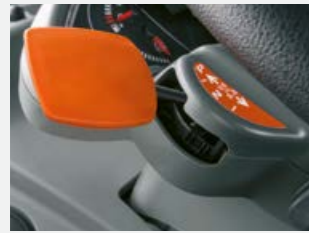
Saadaval REVERSHIFTI suunavahetushoob koos elektroonilise seisupiduriga.
