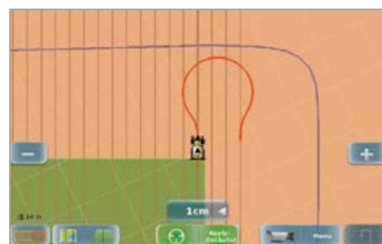
AUTO TURNi abil pöörab traktor põlluotsal automaatselt ümber.
