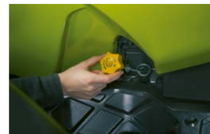
Õlitaset saab kontrollida ja õli lisada kinnise kapotiga.
