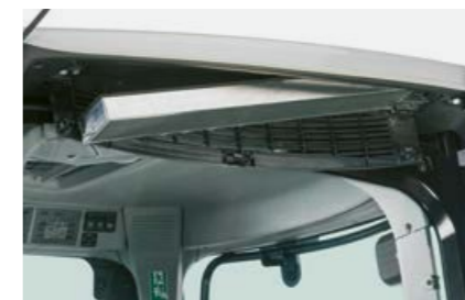
Lihtne ligipääs katuses paiknevale kabiiniõhufiltrile.
