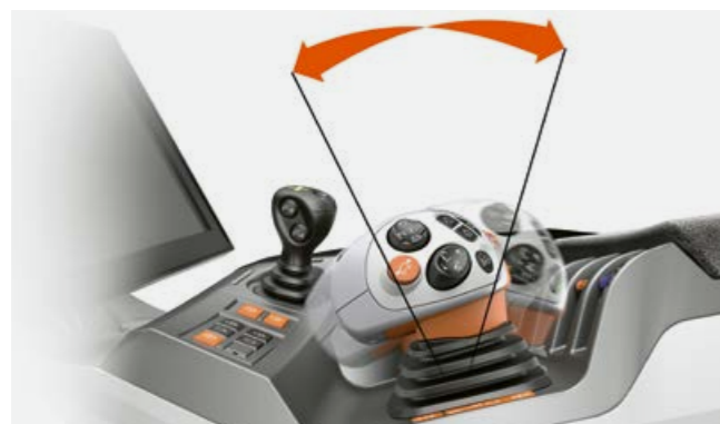
Järgjärguline juhtimine tänu CMATICu astmevaba käigukasti tehnoloogiale.
